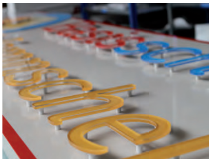
▲ Er is veel vraag naar het gepatenteerde materiaal Acryplus, waarbij letters aan de achterzijde worden geprint. Omdat de zijkanten worden gepolijst, lijkt de letter door en door gekleurd.
